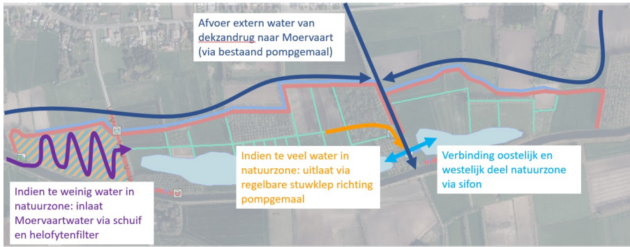
Figuur 12: Schematische weergave van de waterstromen en de hydrologische systeemwerking in normale toestand zonder waterberging, bij vulling van het overstromingsgebied en bij leegloop van het gecontroleerd overstromingsgebied. Weergave van de nodige ingrepen waterbeheer in functie van het realiseren van een gecontroleerd overstromingsgebied Kalvekant-Zuid (uit eindvoorstel Landinrichtingsplan Kalvekant-Reepkens-Oostdonk-Maaibos) (pag 66)
