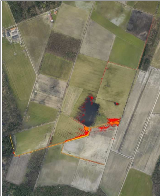
Overstromingsdiepte bij stuwpeil 25,3 mTAW
