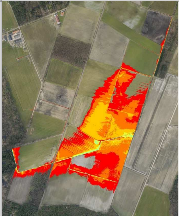
Overstromingsdiepte bij stuwpeil 25,8 mTAW
