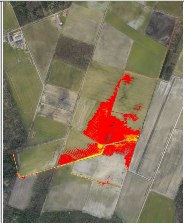
Overstromingsdiepte bij stuwpeil 25,5 mTAW
