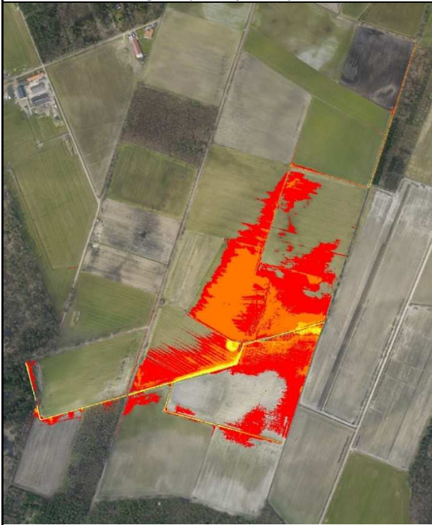
Overstromingsdiepte bij stuwpeil 25,6 mTAW
