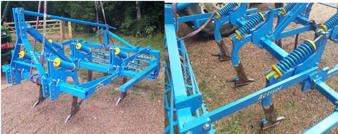
Figuur 121: Actisol met vijf verende tanden
