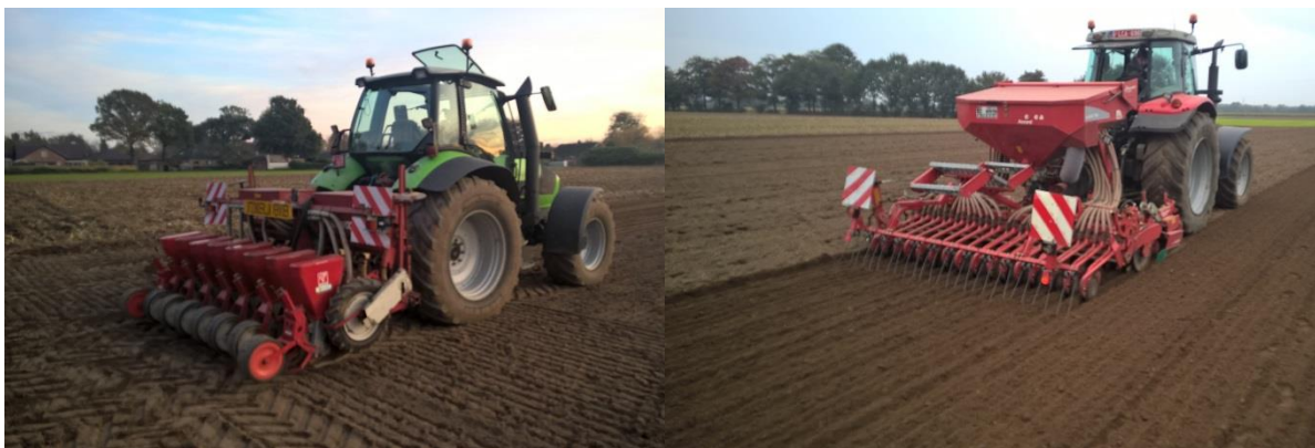
Figuur 189: links: maiszaaiër op halve rijen, rechts: graanzaaiër
