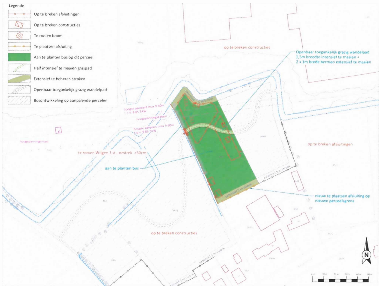
Figuur 19: Ontwerp van de bosbuffer op het deel van perceel Gent, 13 de afdeling, sectie B, 388F
