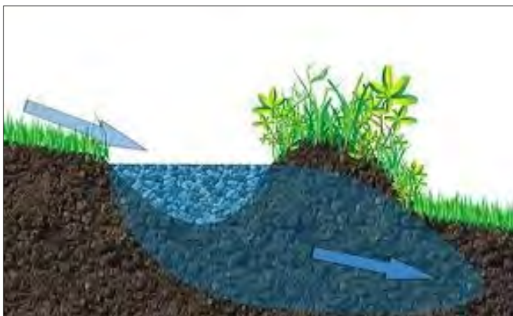
Figuur 57: Een swale is naast een erosiebeperkende maatregel, ook een zone voor waterinfiltratie. Dit komt het milieu ten goede tijdens droogteperiodes.
