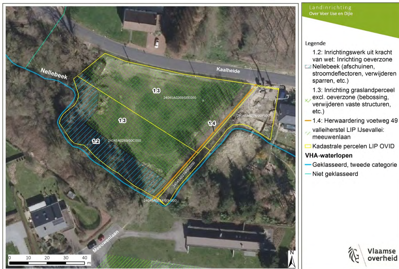
Figuur 33: Inrichtingsmaatregelen t.h.v. planlocatie 'Nellebeek'. Binnen een 10m brede oeverzone wordt het perceel afgeschuind, sparren geroid, afsluitingen verwijderd en inheemse beplanting aangebracht. Via een bebossing van het weiland ontstaat een zeer belangrijke schakel tussen IJsevallei (richting ontharde Meeuwenlaan) en de bossen langsheen de Kaalheide en Nellebeek. De voetweg wordt opgewaardeerd.
