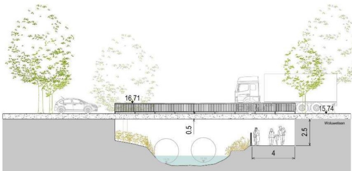
Figuur 22 Dwarsdoorsnede wandel-eco onderdoorgang Woluwelaan
