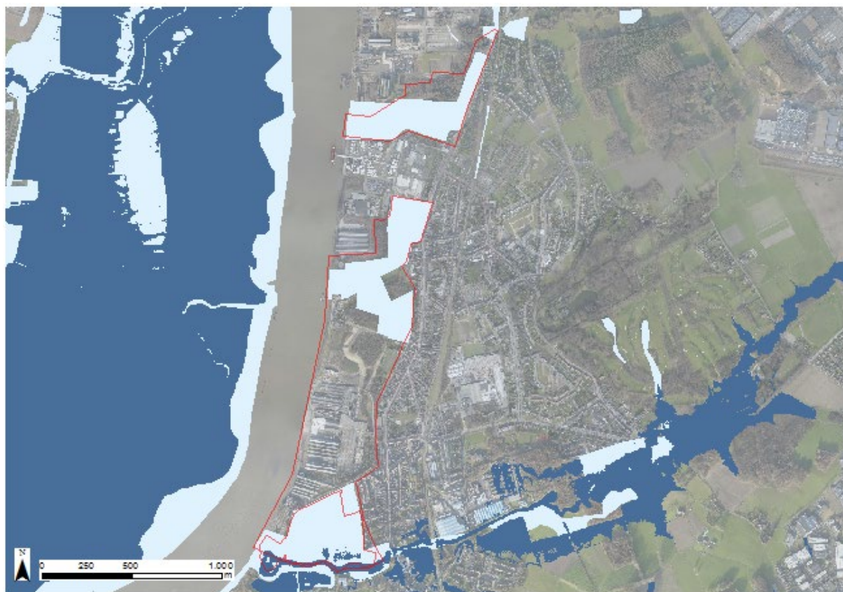
Fig x: Aanduiding overstromingsgevoelige gebieden (2017) (rood: perimeter deelgebied Hemiksem, lichtblauw: mogelijk overstromingsgevoelig, donkerblauw: effectief overstromingsgevoelig)
