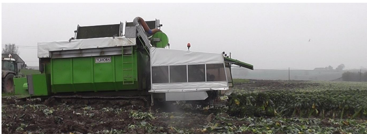
Figuur 45: Afvoeren van spruitstokken met behulp van een omgebouwde oogstmachine (Wulvergem, 28/11/2013).
