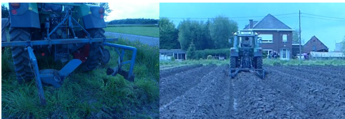
Figuur 54: Gebruikte ploeg (links) voor het aanleggen van gewenten (rechts).
