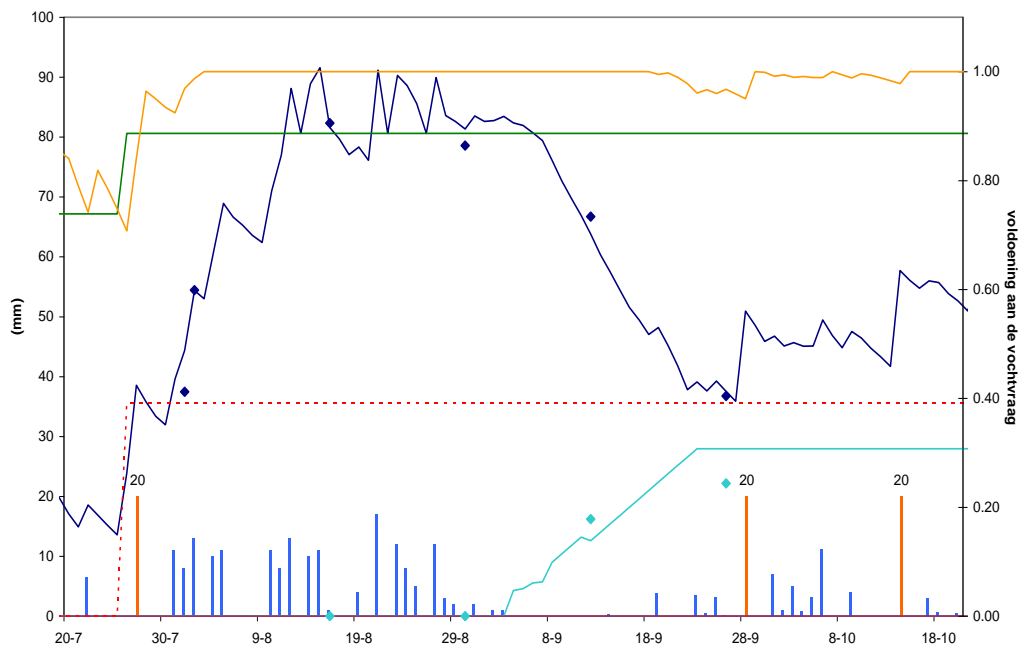
Figuur 57: Verloop van vochtgehalte in bodem van een prei bodemkoolperceel te Oostrozebeke in de periode juli – oktober 2006 (Bron: BDB)
