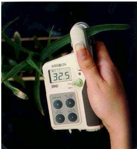
Figuur 68 : De Minolta Chlorofyl meter SPAD-502 gebruikt voor de bepaling van de chlorofyl concentratie ( http://www.agron.missouri.edu/mnl/68/39krugh.html )
