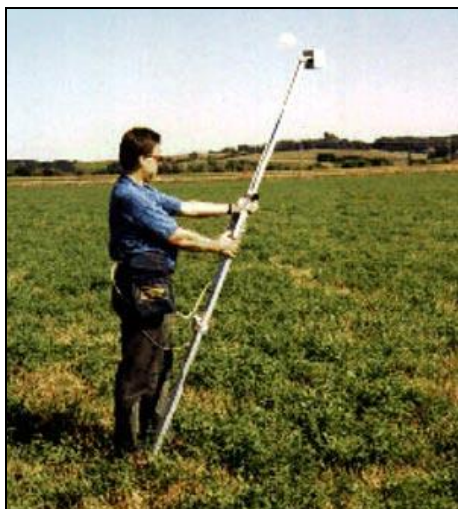
Figuur 71 : Gebruik van de CROPSCAN op het veld
