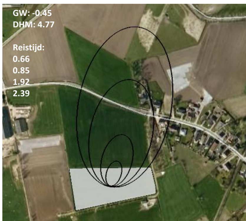
Figuur 2: intrekgebieden voor een hypothetische peilbuis geplaatst in het midden van een perceel op een verschillende diepte. Voor iedere diepte (0,95m; 1,45m; 2,45m en 3,45m) is ook de reistijd weergegeven.
