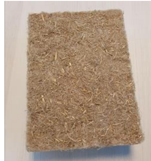
Isolatiemateriaal met 75% tot 90% NewFoss vezels
