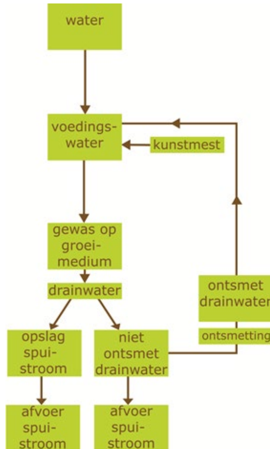
Figuur 4: Schema van de stromen aan water en meststoffen bij een teelt op groeimedium met recirculatie
