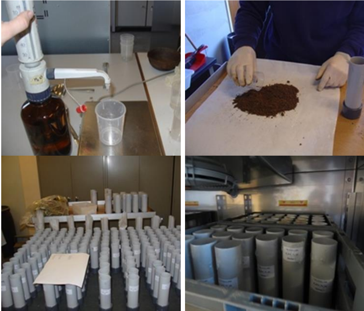
Figuur 7. Afmeten van het toe te voegen water (linksboven), mengen van de organische meststoffen doorheen de bodem (rechtsboven), gelabelde buisjes voor de N-mineralisatieproef (linksonder) en de buisjes in de klimaatkast (rechtsonder).
