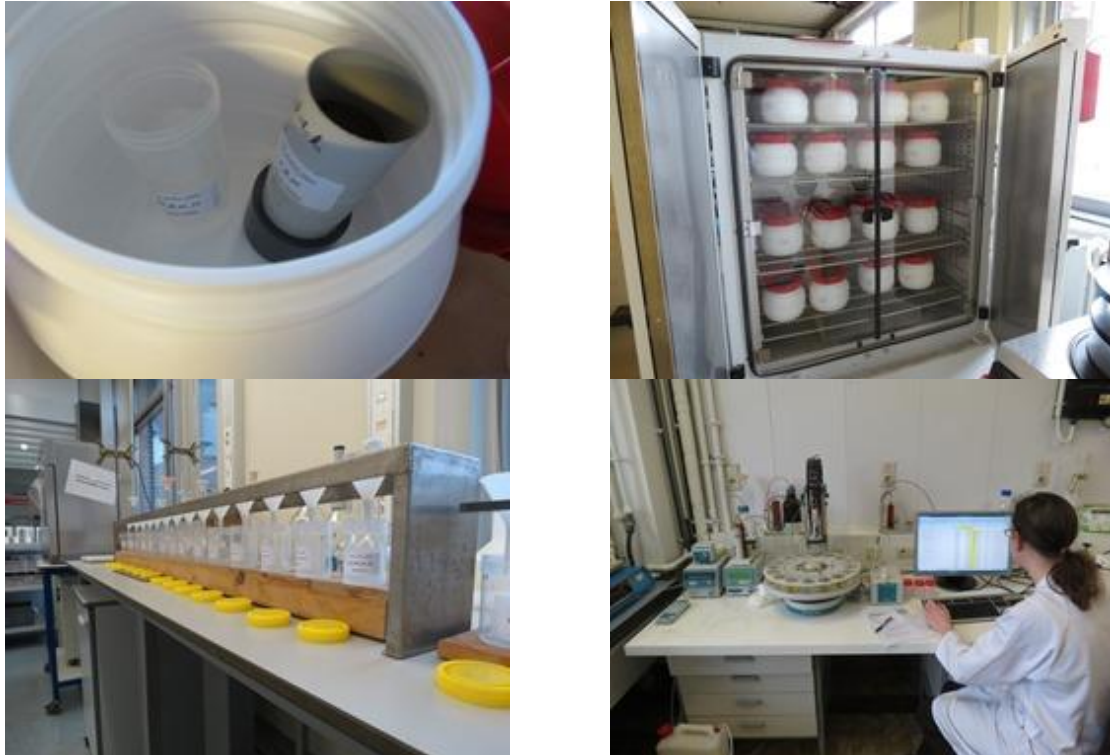
Foto 1. Buisje met bodem-organische meststof mengsel en potje met NaOH-oplossing om de geproduceerde CO 2 in op te vangen samen in een afsluitbaar tonnetje (linksboven), tonnetjes in de klimaatkast (rechtsboven), affiltreren van neergeslagen carbonaten uit de NaOH-oplossing na toevoeging van BaCl (linksonder) en de automatische titratie met HCl ter bepaling van de hoeveelheid geproduceerde CO 2 -C (rechtsonder).
