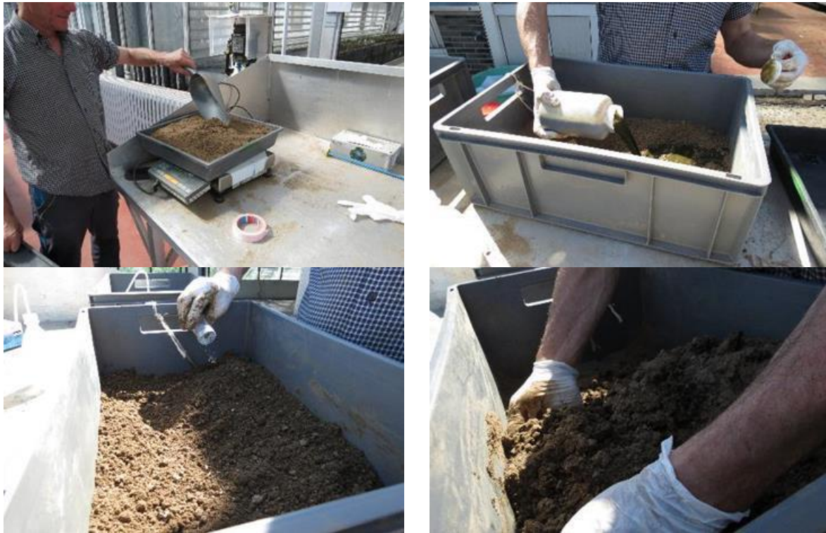
Figuur 62. Afwegen van de bodem (linksboven), toevoegen van de organische meststof (rechtsboven) en minerale meststof (linksonder) aan de bodem en menging van het geheel (rechtsonder).
