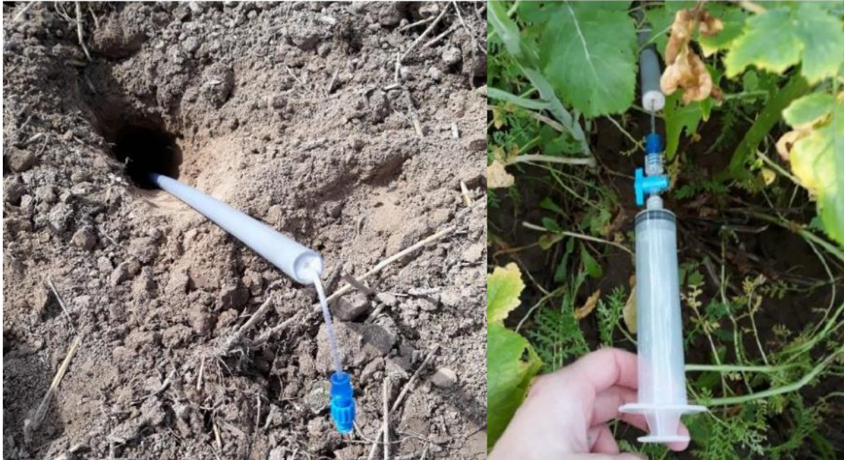
Fig 2.21 Installatie en gebruik van de macrorhizons
