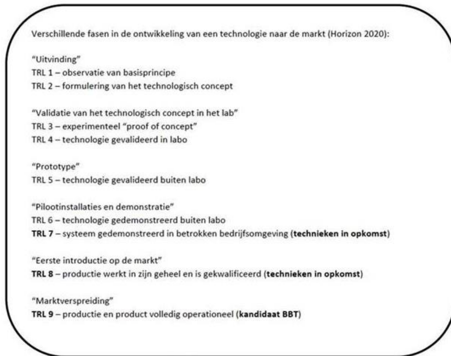
Figuur 86: Beoordeling TRL-score (Technology Readiness Level) gehanteerd bij de ontwikkeling van een technologie (Derden et al., 2020).
