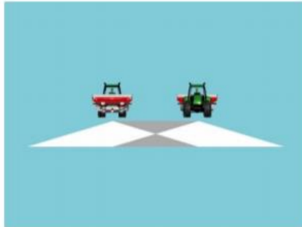
Figuur 128 Strooibeeld van 2 naast elkaar liggende werkgangen (bron: Coopman et al., 2019)
