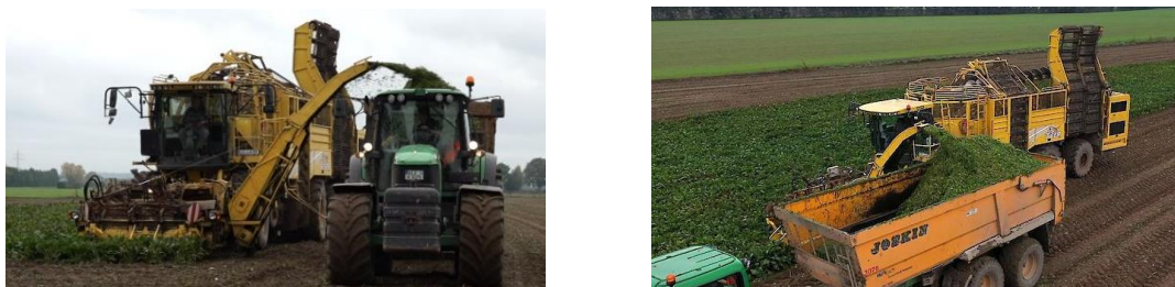
Figuur 144 Bietenrooier met gemonteerde afvoer voor gehakselde bietenbladeren (bron: www.trekkerweb.nl , 2020).
