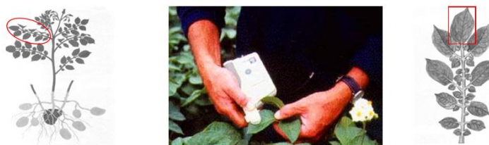
Figuur 78: Duiding op welk blad de meting met de Hydro-N-tester moet uitgevoerd worden. (Goffart et al., 2005)
