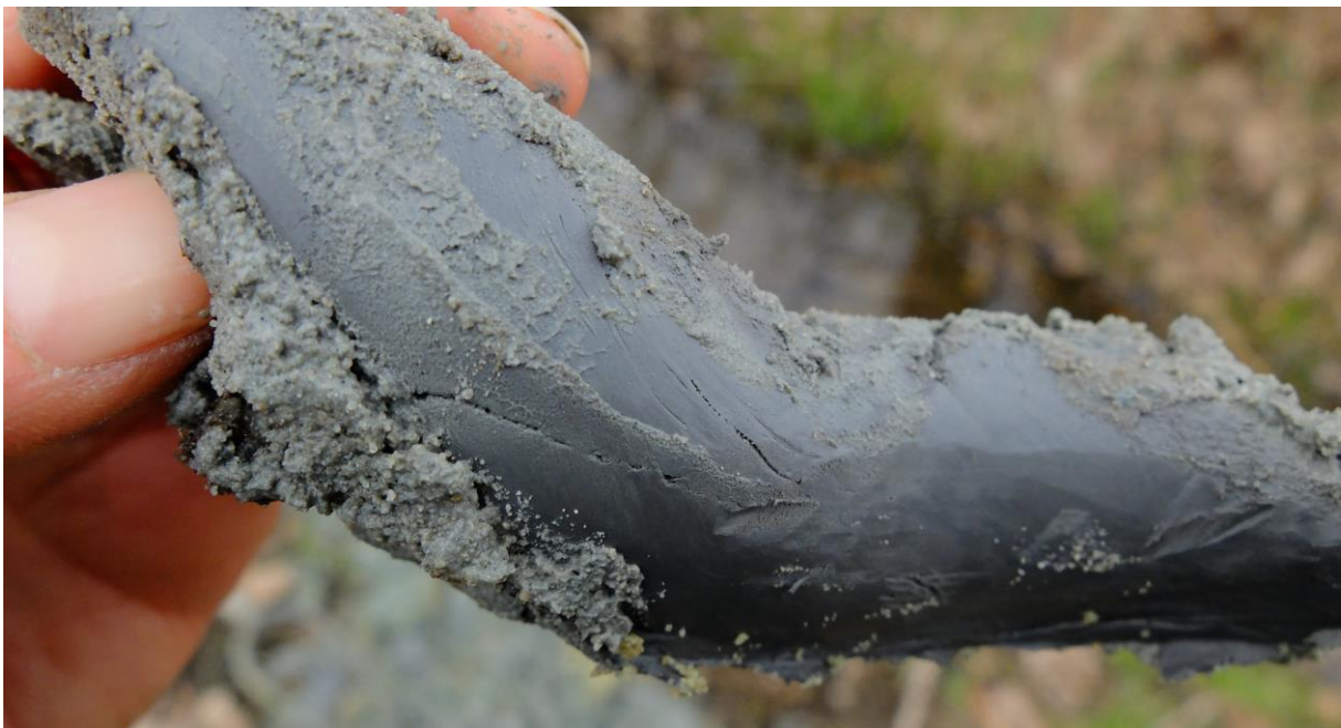
Fig 3.3 Bij het boren van PB2 en PB5 werden ondiepe compacte kleilaagjes aangetroffen
