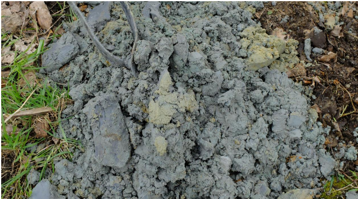
Fig 3.3 Bij het boren van PB2 en PB5 werden ondiepe compacte kleilaagjes aangetroffen
