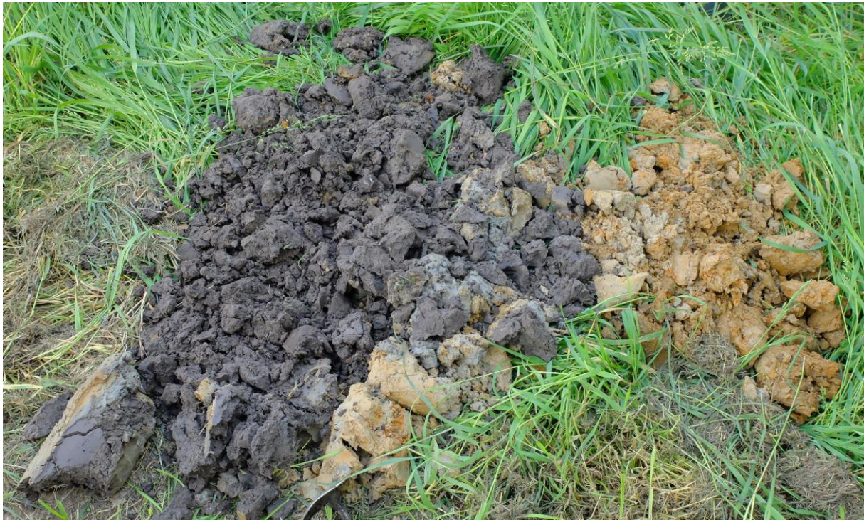
Fig 3.3 Roestsporen in de bovenste geoxideerde laag
