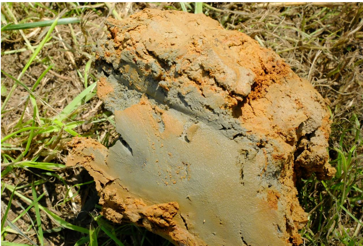
Fig 3.3 Roestsporen in de bovenste geoxideerde laag
