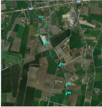
Fig 3.1 Ligging van de 5 geïnstalleerde peilbuizen in testsite Peer
