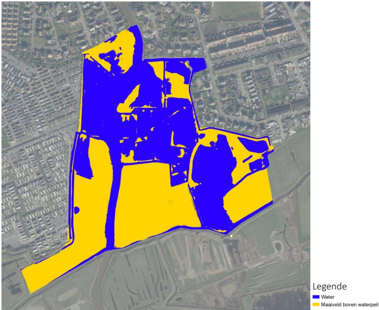
Figuur 8: situering huidige buffercapaciteit in compartiment 4 bij waterpeil 2,2 m TAW
