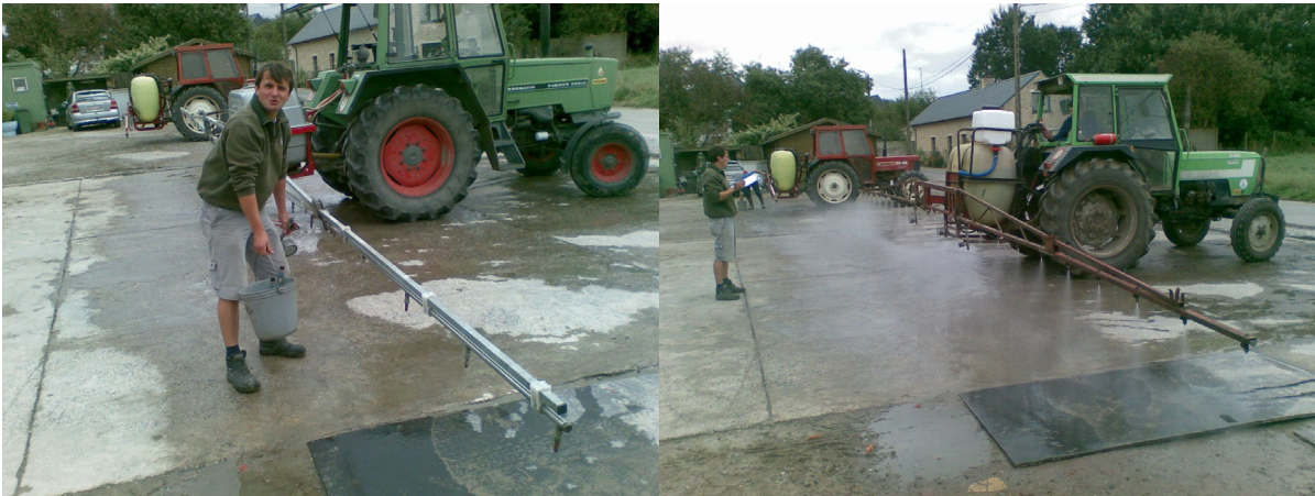
Figuur 58: Keuring spuittoestellen – momenteel wordt bij de keuring de goede werking van de verschillende onderdelen gecontroleerd (debiet doppen, druk per sectie spuitboom, enz.) alsook de onderhoudstoestand/veiligheid van het toestel
