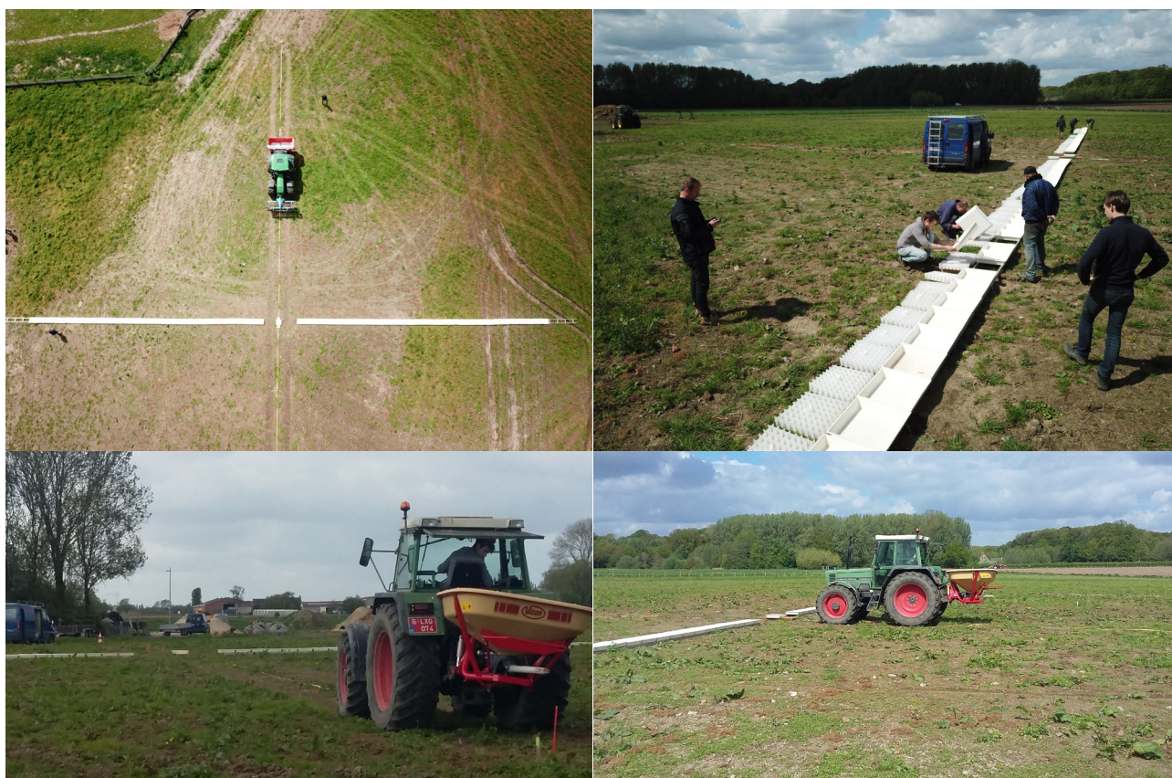
Figuur 61: Foto's van de verdelingsmetingen met de Vicon pendelstrooier (standaard- en kantstrooi-instellingen)
