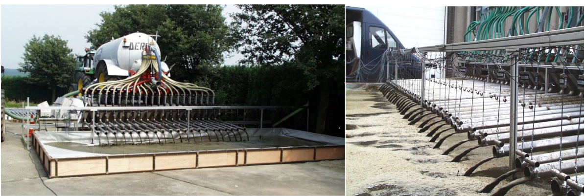
Figuur 60: Testopstelling voor het doormeten van emissiearme toedieningstechnieken voor mengmest
