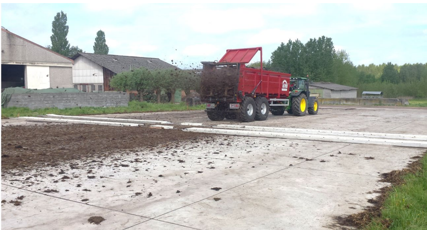
Figuur 31: Verdelingsmeting van een stalmestverspreider m.b.v. 2 rijen opvangbakjes in overeenstemming met de Europese norm EN 13080 (2003)
