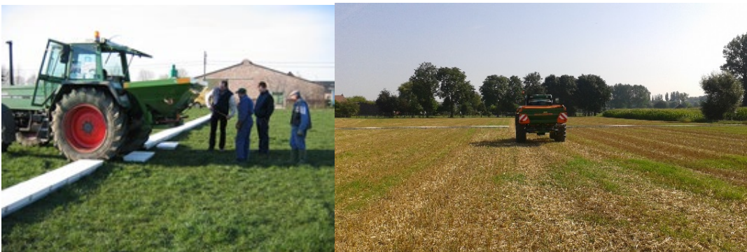
Figuur 30: Opmeten van spreidingspatroon van een kunstmeststofstrooier met behulp van klassieke opvangbakjes
