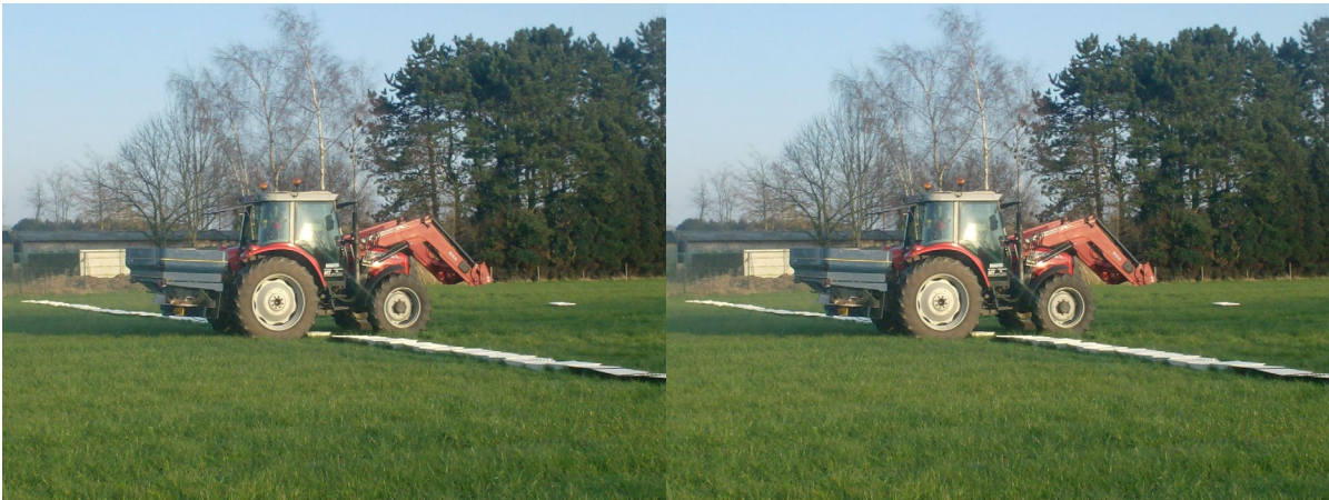
Figuur 59: Opmeten van het transvers strooibeeld via collectiebakken met roosters. Deze worden nadien afzonderlijk gewogen
