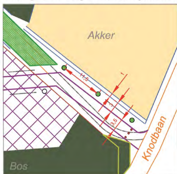
Aansluiting Knodbaan deel 5: Pad verleggen en verbreden, Aanleg berm en gracht, Verwijderen begroeiing
